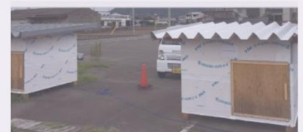
同じサイズの試験棟を2棟使用 左が折板屋根そのまま、右がスカシート施工
